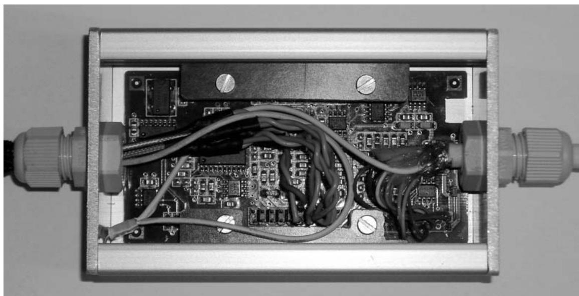
Abbildung 7.12 Externe Elektronik zur Aufbereitung der Sensorsignale
