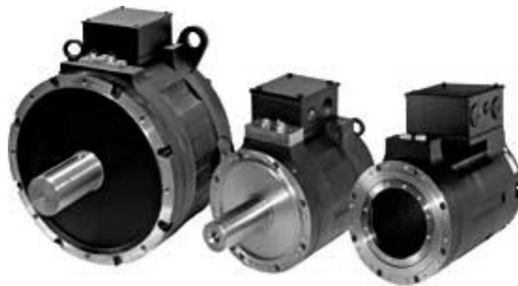
Abbildung 1.12 High Torque Motoren, wassergekühlte permanenterregte hochpolige Synchronmotoren, ganz rechts in Hohlwellenausführung, Quelle: *Baumüller Holding GmbH*
