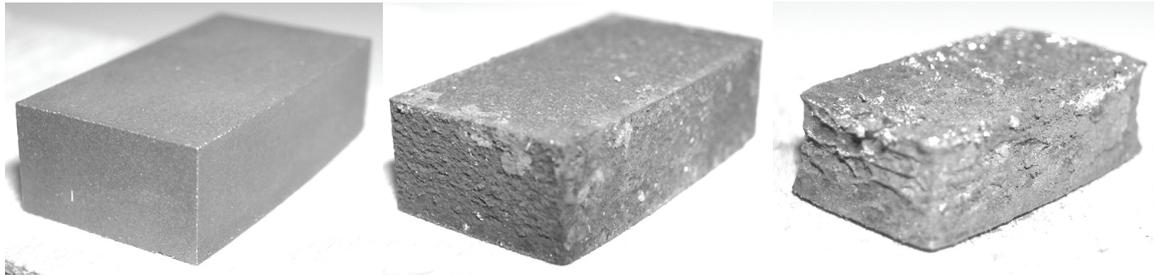
Abbildung 6.4 SmCo Magnet in 30% Salzsäure eingelegt, neu, nach 24 Stunden, nach 85 Stunden
