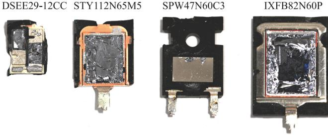
**Abb. 4.3:** Geöffnetes Gehäuse einiger, der in Tab. 4.2 und Tab. 4.4 aufgelisteten Bauteile.
