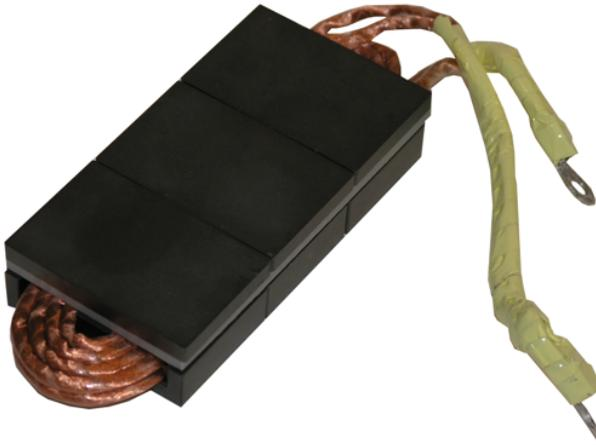
**Abb. 4.28:** Spule für CF-ZVS-M-Konverter Prototyp, realisiert mit EILP43-Kernen und zwei parallel geschalteten Wicklungen à 4 Windungen. Daten der Hochfrequenz-Litze:  $d_s = 0.05$  mm,  $N_s = 2000$ .
