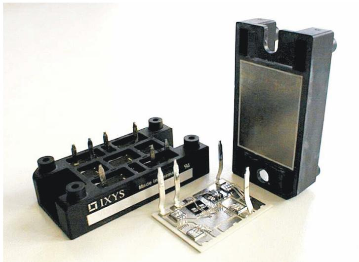
**Abb.2.48:** Halbleitermodul IXYS VUI 31-12N1 das die Halbleiterbauelemente eines Brückenzeigs der Tiefsetzstellereingangsstufe integriert.
