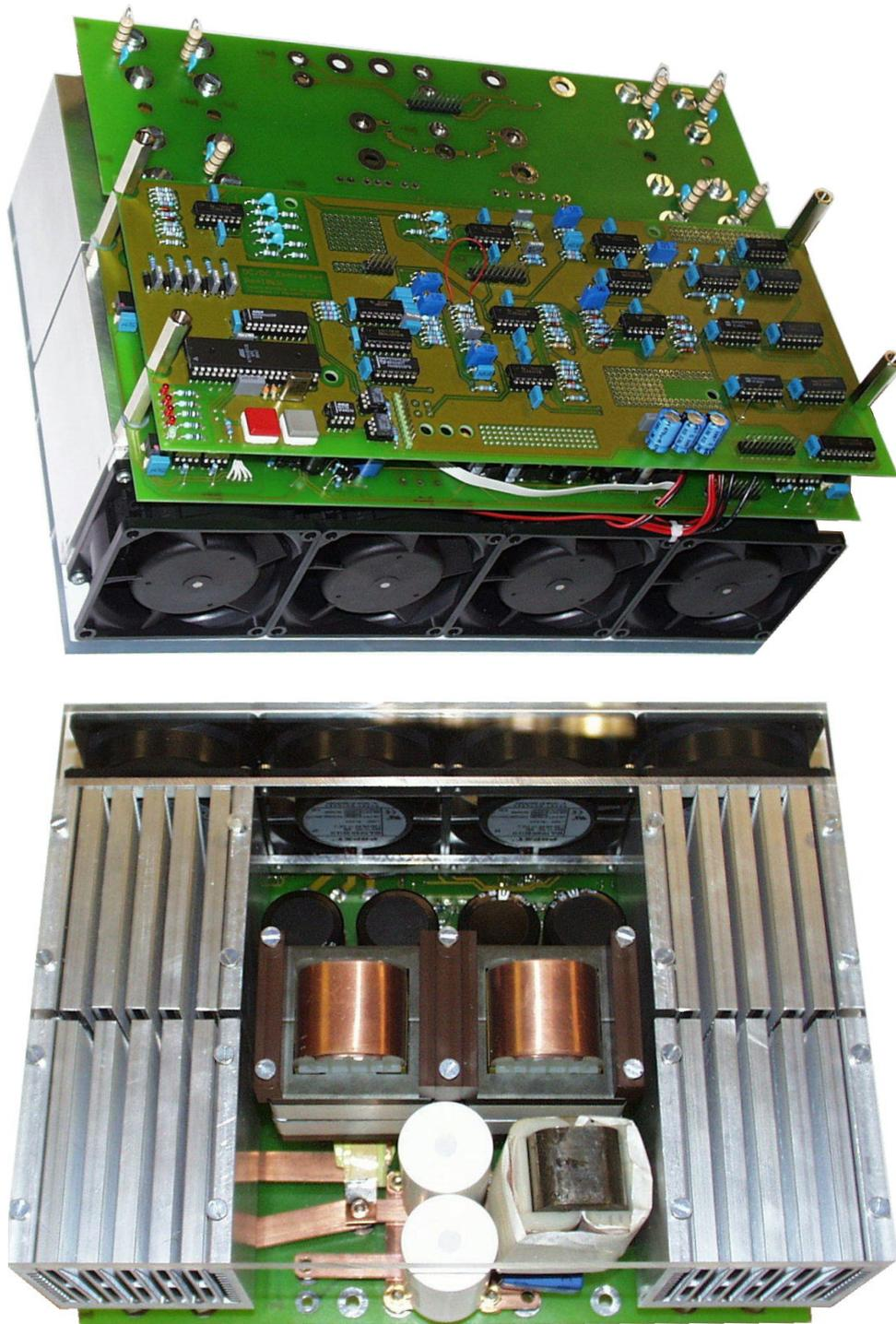
**Abb.8.18:** Fotos des industrienah realisierten Prototyps des DC/DC Konvertersystems.
