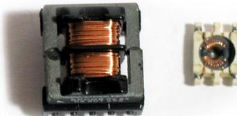
**Abbildung 2.15:** Transformator bei direkter (links, E13 Kern) und gepulster Ansteuerung (rechts, R4 Kern).
