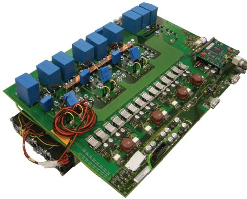
**Abbildung 5.3:** Foto des zur Validierung des Regelungskonzepts verwendeten Buck+Boost-Konverters.
