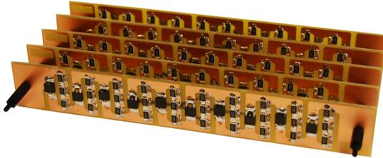
**Abbildung 4.58:** Die zur Modellierung des Klystrons verwendete 50 kV-100 A-Hochspannungsdiode.
