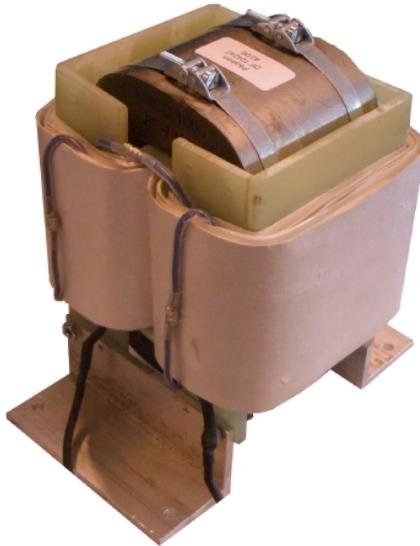
**Abbildung 4.20:** Realisierte Drossel der passiven Vormagnetisierungsschaltung mit den Kenndaten aus Tabelle 4.3 (b x h x w = 16 cm x 18 cm x 15 cm).
