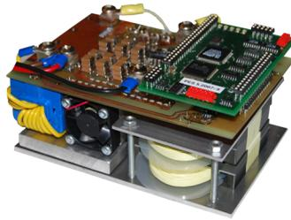
Abbildung 4.53: Foto des DC/DC-Wandlers zur Kondensatorladung.
