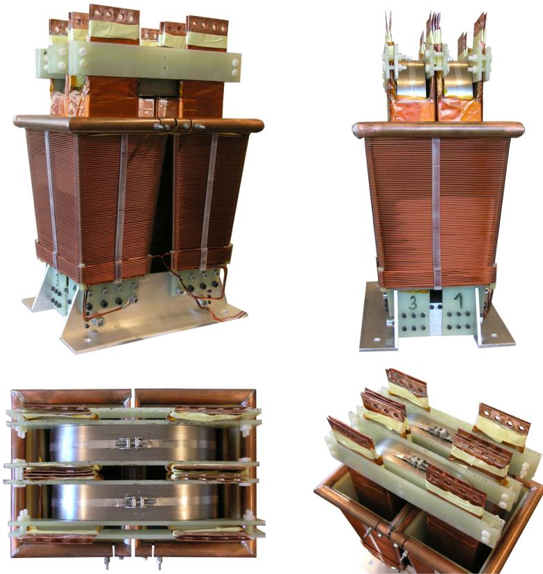
**Abbildung 3.69:** Fotos des Pulstransformators für das 20 MW Halbleiter-Leistungsmodulator-System.
