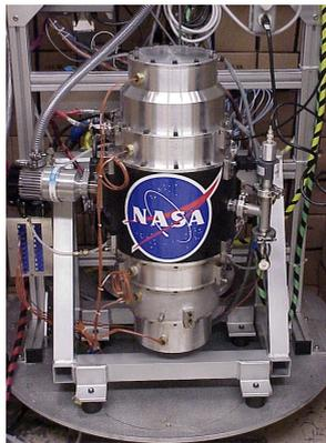
**Abb. 2.4:** Magnetisch gelagertes Schwungrad der NASA in teilluftentleertem Raum zur Energiespeicherung [27].
